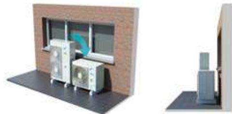
Блоки сверхкомпактны: их высота – всего 82 см.
